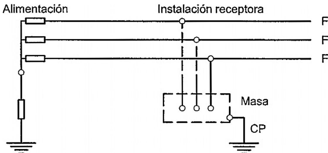
En este esquema la intensidad resultante de un primer defecto fase-masa o fase-tierra, tiene un valor lo suficientemente reducido como para no provocar la aparición de tensiones de contacto peligrosas.
