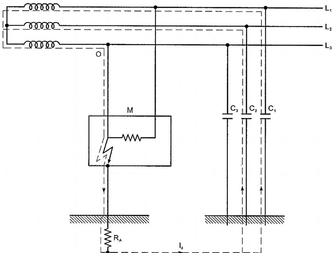
Figura 6. Esquema IT unido a tierra por impedancia Z y con las puestas a tierra de la alimentación y de las masas separadas
